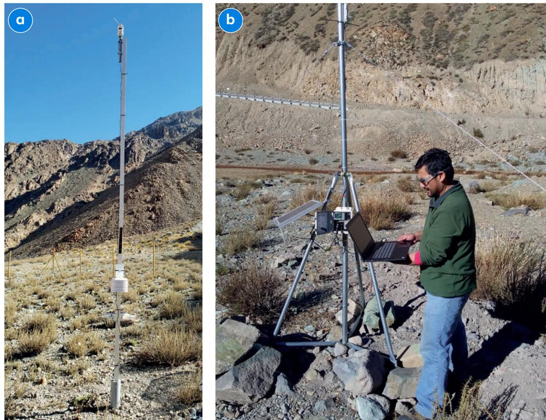
Figura 7. a) Unidad con sensor de suelo y ambiental y b) estación climática de almacenamiento de datos.
