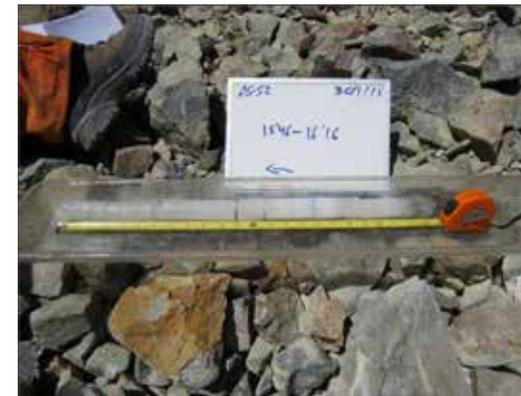
**Figura 2.** Muestra de hielo entre 15,46 y 16,16 m en el sondaje AS-S2 del glaciar Altar Sur.
